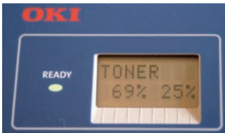
Fig.1-3: Capacidade para 6000 e 2500 páginas do cartucho de toner
