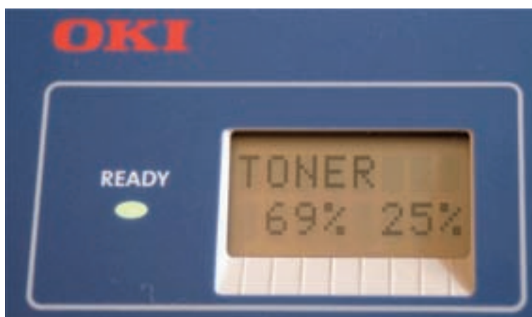
Abb.1-3: Füllmenge in Prozent von Tonerkartuschen für 6000 und 2500 Seiten
