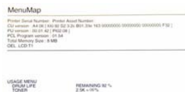
Fig.1-2: Etat de la durée de vie du toner et du tambour
