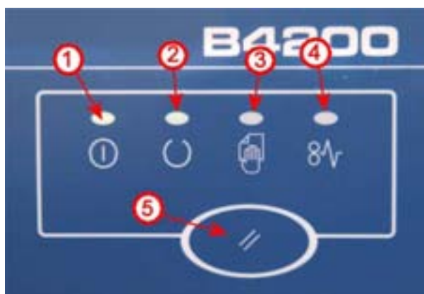
Fig.1-1: Led (diode électroluminescente) et bouton de commande de l'imprimante
